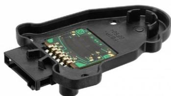
Электронные модули датчиков педали включают в себя педаль акселератора, датчик угла поворота и механику для имитации традиционного ощущения водителя педалью акселератора.
